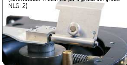
Control del nivel de llenado (indicador de proximidad capacitivo para grasa fluida del grado NLGI 1, 0, 00, 000)
